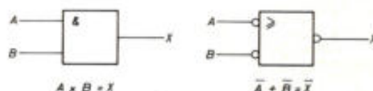
Fig. 12. EN voor H-sigitaal = OF voor L-sigitaal.
